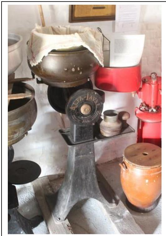
Au musée, nous disposons de différents modèles d'écémages Alfa-Laval, Mélotte et d'autres marques encore. Les machines étaient actionnées à la main via une manivelle ou par une roue à chiens.
