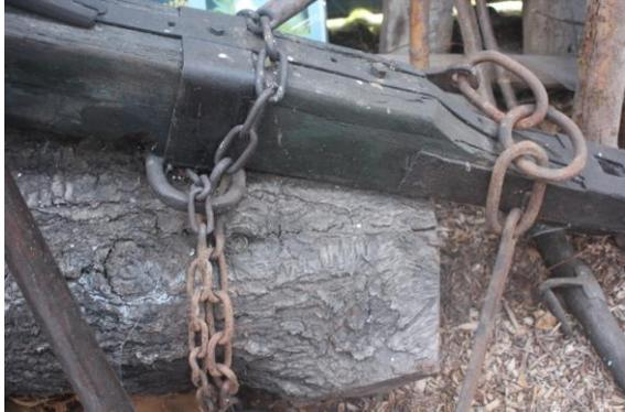
Selon la longueur de la grume et le terrain, l'opérateur peut aussi suspendre la grume en équilibre sous le triqueballe ou attacher l'engin à l'avant de la grume et laisser celle-ci glisser à l'arrière sur le sol.
